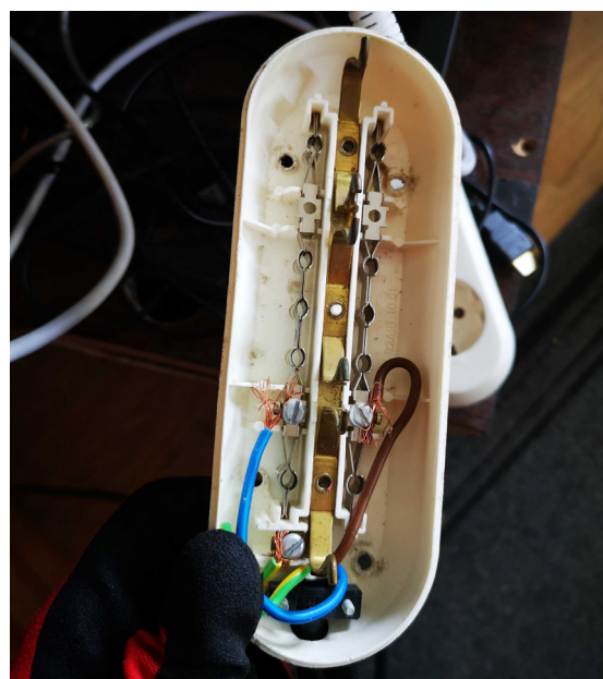
Kuva 17. Ei-ammattilaisen tekemä jatkojohto.
